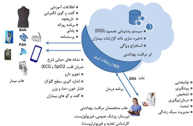
شکل ۱. معماری‌های سیستم نظارت بر سلامت راه دور خانگی مبتنی بر IOT
